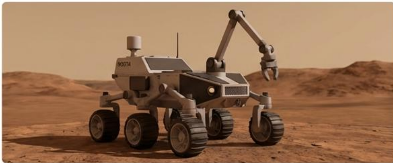
ROSITA (Robot Spaziale Italiano): Un rover per l'esplorazione planetaria, programmato in Python per simulare missioni su Marte.
