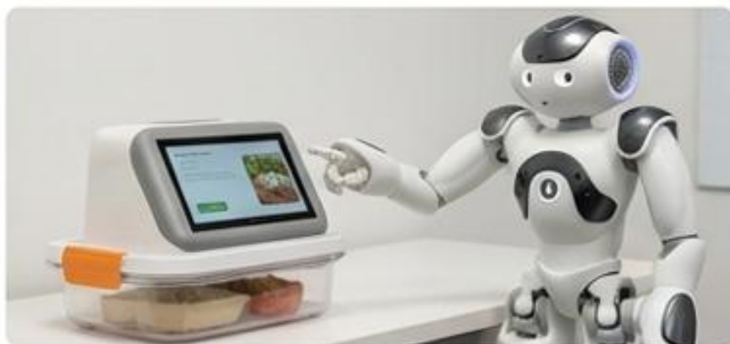
NAO & Smart Food Conservation System: Un sistema IoT e AI che, con l'aiuto del robot NAO, monitora la qualità del cibo e assiste le persone ipovedenti.
