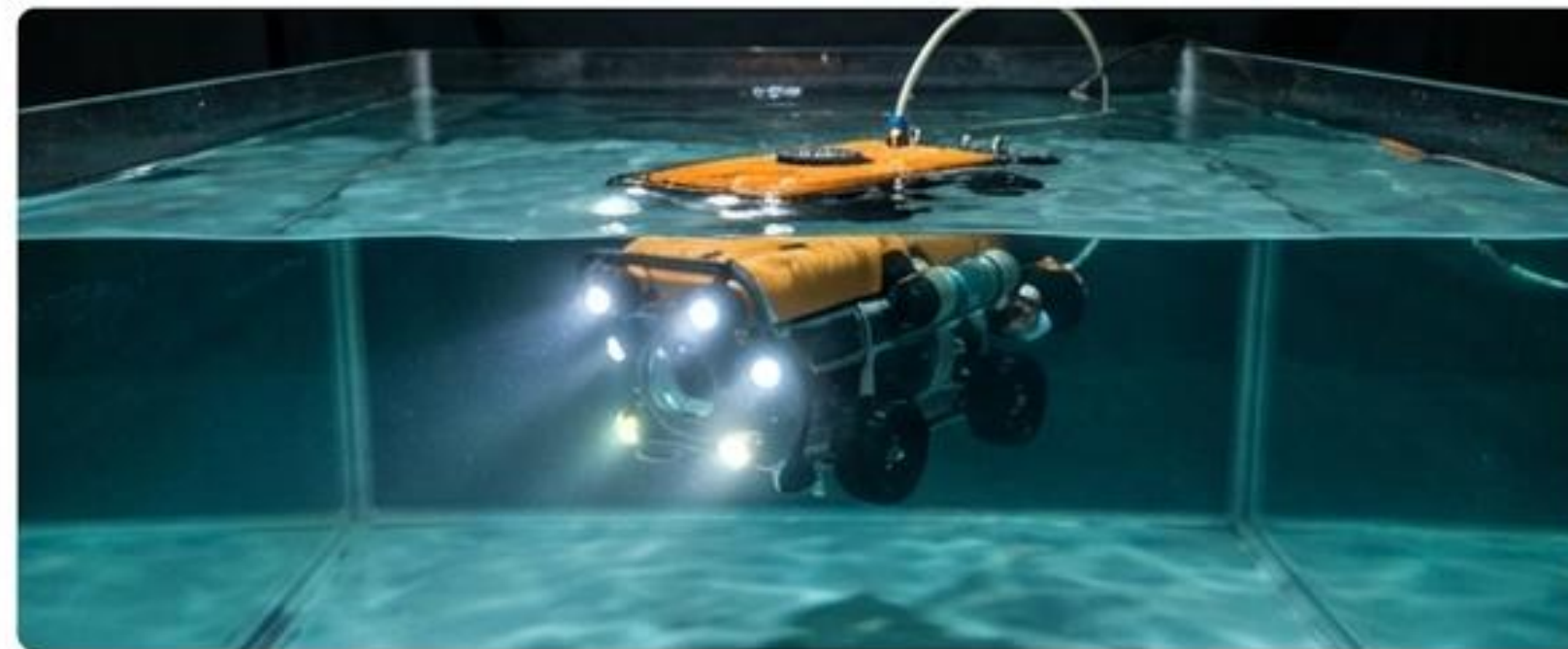
MARCONI ROV EXPLORER (MRE): Un rover sottomarino per monitorare l'ambiente marino, comunicando via Codice Morse in omaggio a Marconi.
